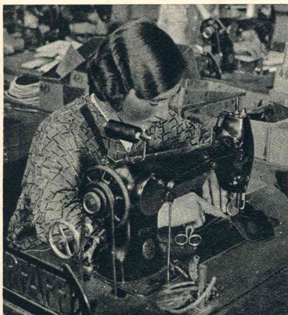
Met de machine (een der vele!) wordt het voorblad opgestikt.
