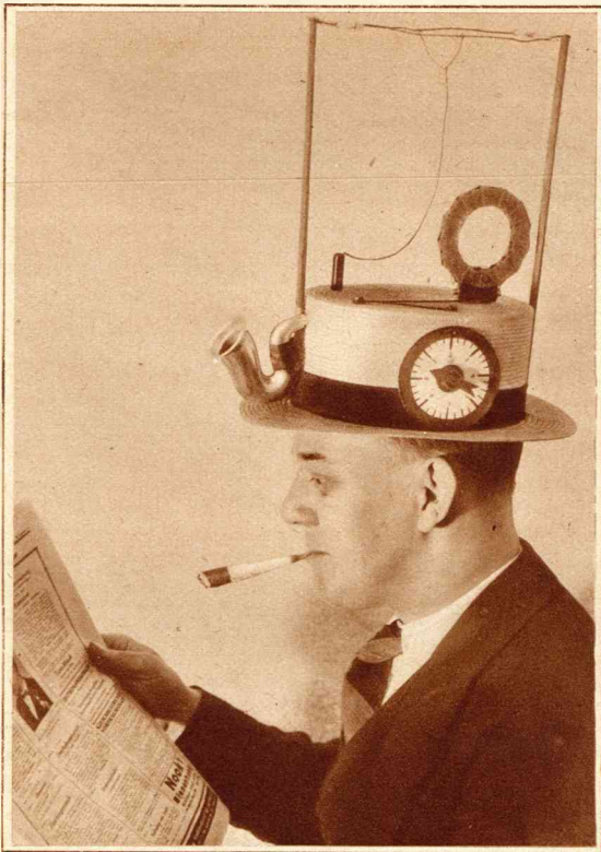
DE NIEUWSTE RADIO-ONTVANGST. Een geestdriftig en vernuftig radio-liefhebber is op de gedachte gekomen, om tijdens zijn wandeling op straat toch te kunnen genieten van de geluiden, die er in de lucht langs elektrische golven zich voortbewegen, door op zijn hoed een volledige ontvangst-inrichting aan te brengen, van de antenne af tot den luidspreker toe. Een voorbeeld ter navolging voor de radio-maniakken onder onze lezers!
