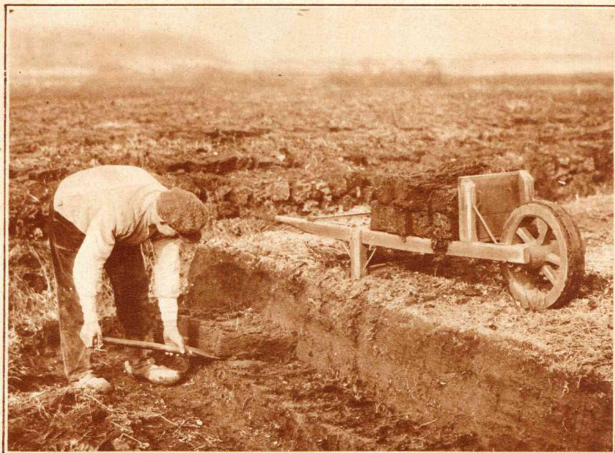
Het brandbare goedje wordt in groote brokken gesneden en daarna als „turf“ op platte kruivagens naar de stapelplaats gevoerd.
