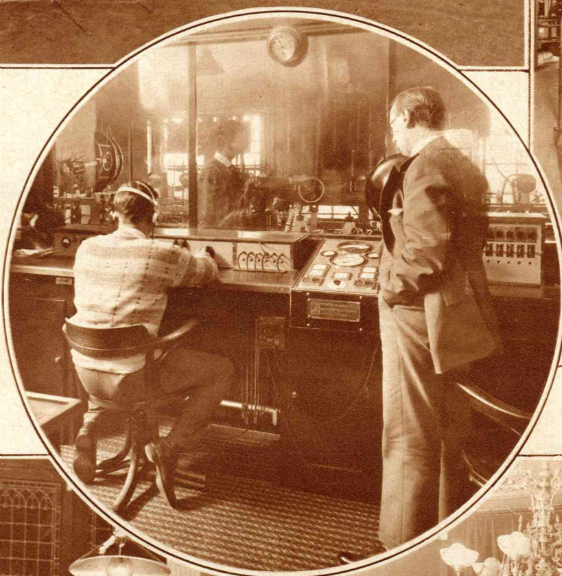
In de zendkamer. Men ziet voor den condensator de tusschenkringspoel, daarnaast het gelijkrichtframe voor eindlampen en geheel rechts de antennespoelen.
