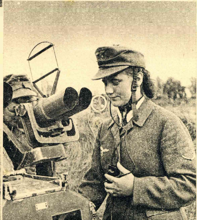
De gehoorapparaten zijn de ooren, waarmee men het geluid van naderende vliegtuigen opvangt. Daaronder: Per telefoon worden de orders ontvangen en doorgegeven.
