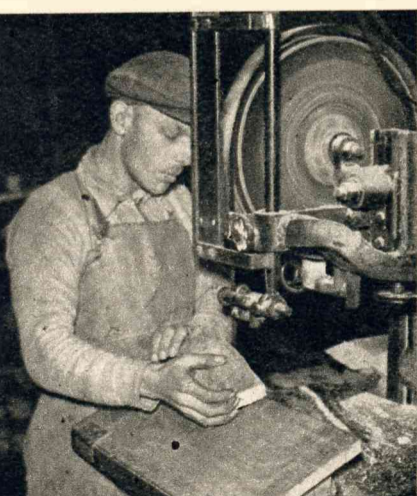
Het overtollige hout wordt weggezaagd.
