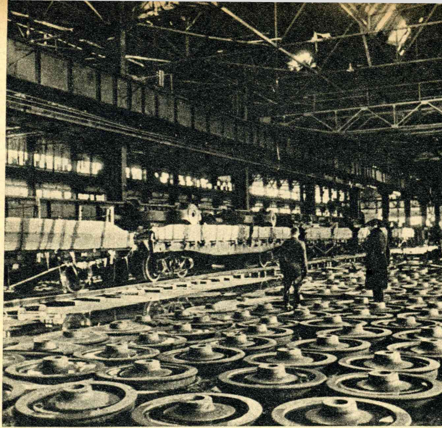
In een grote pletterij liggen vele massieve spoorwielen voor verzending gereed.
