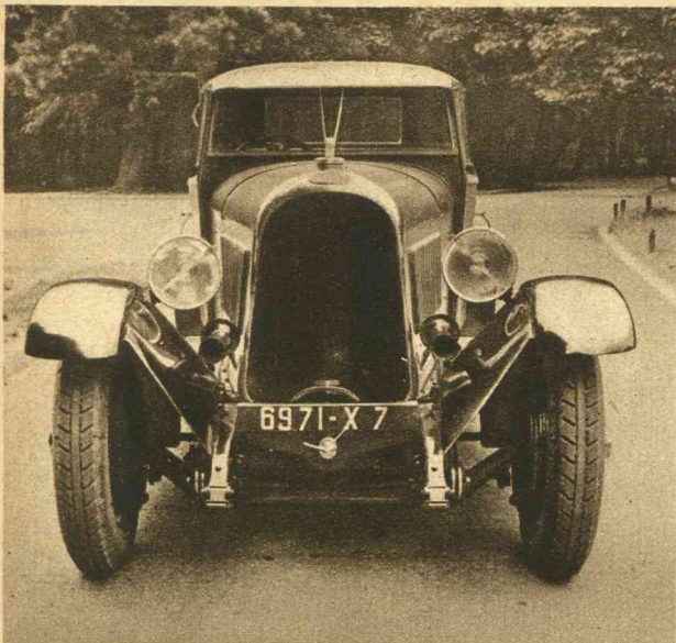
De voorzijde, die duidelijk den zeshoekigen vorm van het koetswerk toont met de grootste breedte ter hoogte van de schouders.
