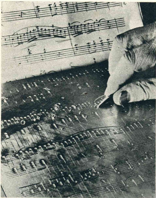
De vakman controleert nauwkeurig of alles, wat op de copie staat, ook op de plaat voorkomt. Verbindingsbogen en dergelijke worden er met de vrije hand in aangebracht.
