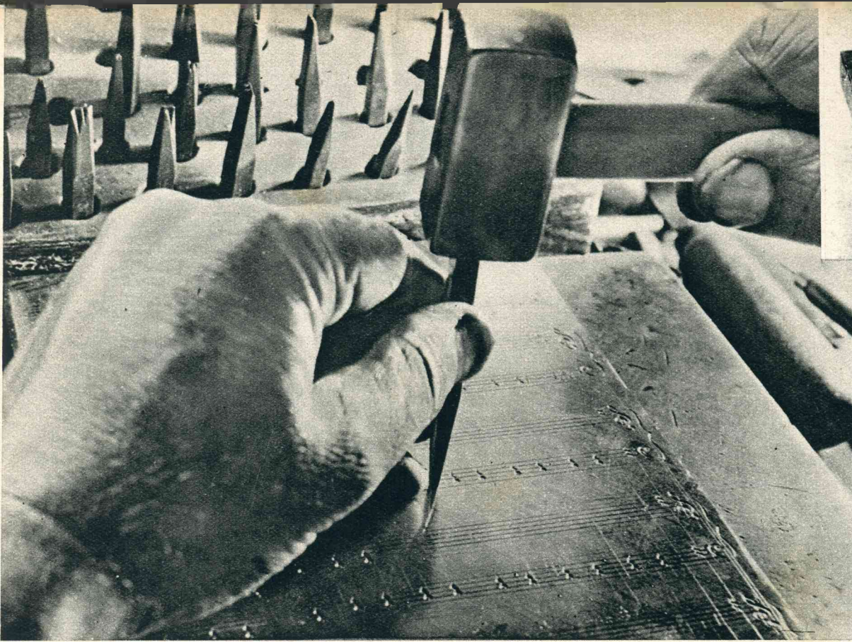
De metalen plaat, waarop de noten worden gegraveerd, bestaat uit een mengsel van tin, antimonium en lood. Nadat de notenbalken er met een speciaal apparaat zijn ingegraveerd, worden de noten zelf er met stalen stempels ingeslagen.
