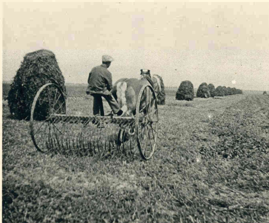
Als een soort duizendpoot kruipt de machinale hark over den hooiakker om de verspreide sprieten bijeen te garen.
