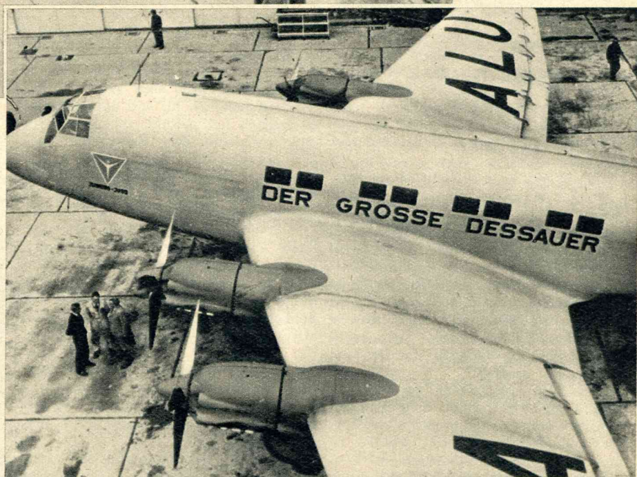
Het nieuwe viermotorige verkeersvliegtuig van de Junkerswerke te Dessau, dat dezer dagen is gereed gekomen. Het biedt plaats aan 40 passagiers, weegt omstreeks 22 ton en kan een snelheid bereiken van 400 km. per uur. Boven: de geweldige machine op het vliegveld. Onder: interieur van de enorme cabine.
