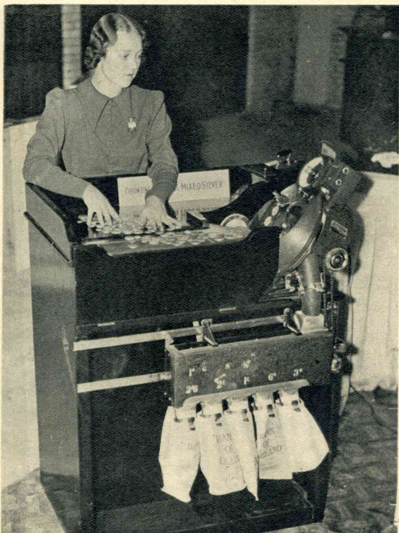
Op de zoogenaamde „Business Efficiency“-tentoonstelling te Earl's Court (Londen) werd de hierboven afgebeelde geldtelmachine gedemonstreerd, welke voor groote banken en wisselkantoren een ware welkomst beteekent. Ze sorteert en telt de geldstukken niet alleen, maar sluit ze nog netjes in afzonderlijke zakjes.
