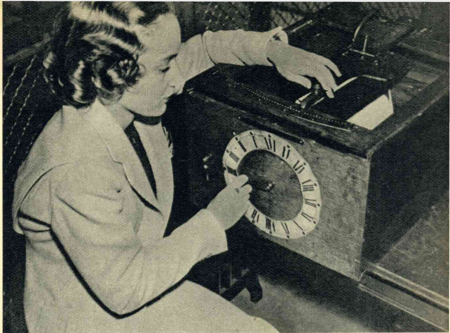
Reeds in 1829 was een zekere A. Burt op het idee gekomen om een schrijfmachine te construeeren. Zijn machine bestond voor het grootste gedeelte uit hout, maar is thans, na 108 jaren, nog steeds bruikbaar.
