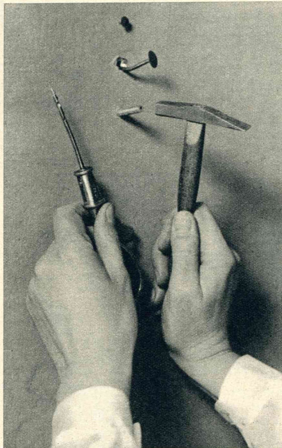
Een verkeerd en een goed ingeslagen spijker.
