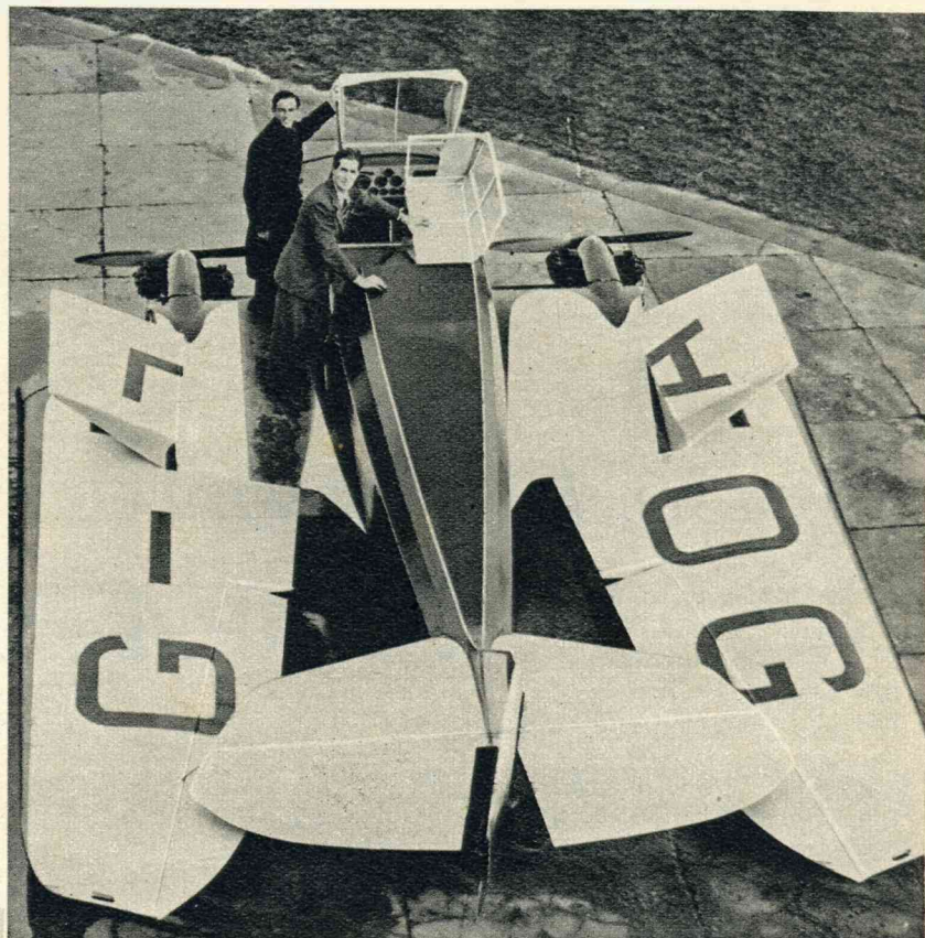
De hertog van Richmond en een monteur, mr. E. Hordern, hebben een nieuw, licht vliegtuig geconstrueerd, hetgeen ze het ideale toestel voor particuliere piloten noemen. De vleugels kunnen gemakkelijk opgerouwen worden, zoodat men de machine zonder bezwaar in een gewone garage kan opbergen.
