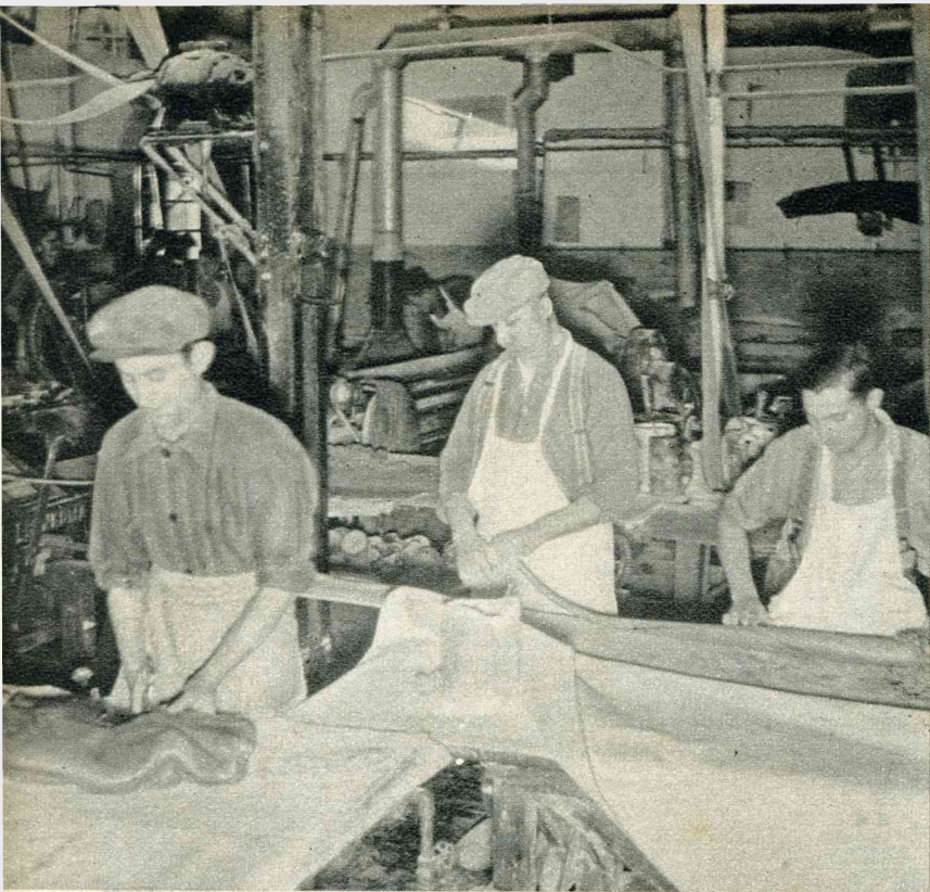
In de groote ketels gesmolten, gemengd en gekookt, wordt het zoete materiaal weer afgekoeld en opgestijfd, in groote lappen gerold en gekneed, om ten slotte, tot dunne staven uitgerold, in de machines te verdwijnen...
