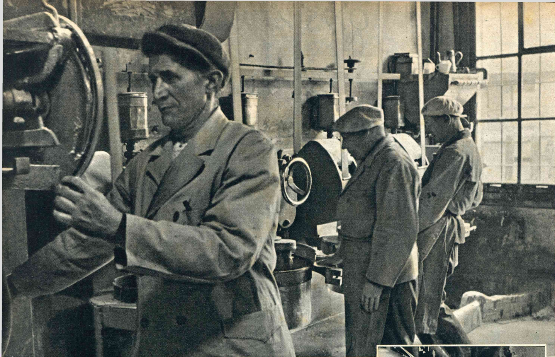
De deegmengmachines, waarin het meel en het water zonder bijvoeging van zout of wat dan ook gemengd worden. Links is de Jacobs ladder met de bakken, waarin het deeg naar boven wordt gebracht om dan door de walsen der machine geplet en gesneden te worden tot matzes.
