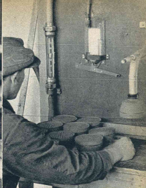
Hier controleert men het doorlatingsvermogen van de filterbus — de meter links wijst aan, dat 80 liter lucht per minuut de filterbus passeert; in het midden een peilglas, door middel waarvan de weerstand van de filterbus in millimeters waterdruk kan worden opgenomen.
