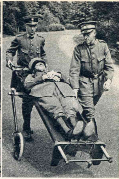
Zonder fiets kan de brancard ook gebruikt worden; de wielen worden dan naar voren verplaatst.
