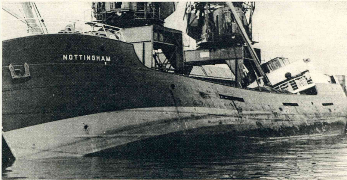
In de Merwehaven te Rotterdam kantelde vorige week door foutief ontluden van den ballast het stoomschip Nottingham, van de Scheepvaart- en Steenkolenmaatschappij. Gelukkig kwam het nog slechts tegen den wal terecht. Indien de slagzij zoowel naar de zijde van de rivier gemaakt was, zou het schip onherroepelijk gezonken zijn.
