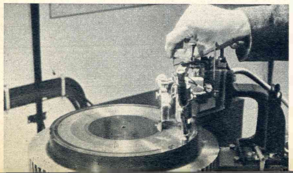
De opname op de wasplaat. De opnamemachine draait, op den achtergrond de versterker. Voorgrond links de microscoop, waardoor de gesneden groeven worden gecontroleerd. Het graveeren van de geluidstrillingen in de wasplaat gebeurt met behulp van een saffier.
