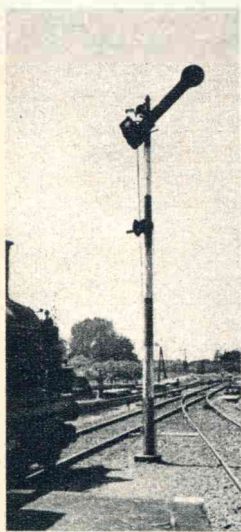
Veilig! Een hoofdseinpaal der Nederlandsche Spoorwegen. Zooals men ziet is het „blad” aan 't uiteinde cirkelvormig verbreed. Voorseinpalen hebben altijd een geheel recht „blad”.
