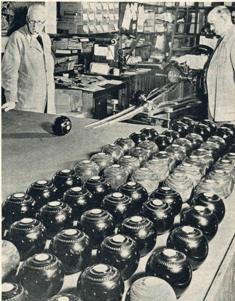
Een kijkje in een kegel- en kegelballenfabriek te Martlake nabij Londen. De ballen worden vervaardigd uit een harde, Indische houtsoort en ieder stel van vier ballen en kegels is afkomstig uit denzelfden boomstam.
