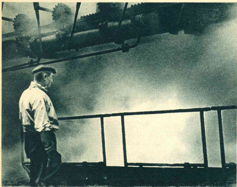
De tot cokes geworden gloeiende steenkool, waaruit het gas ontweken is, valt bij de ontlating uit den kamerooven, waarvan de bodem hydraulisch geopend wordt.
