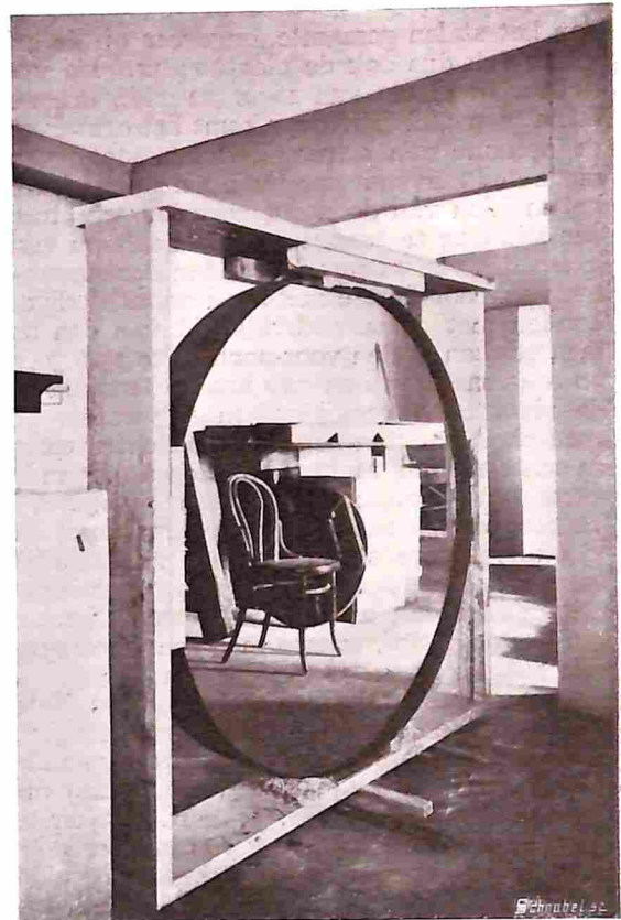
DE SPIEGEL VAN 1.52 METER MIDDELLIJN NA HET VLAKSLIJPEN EN POLIJSTEN.
