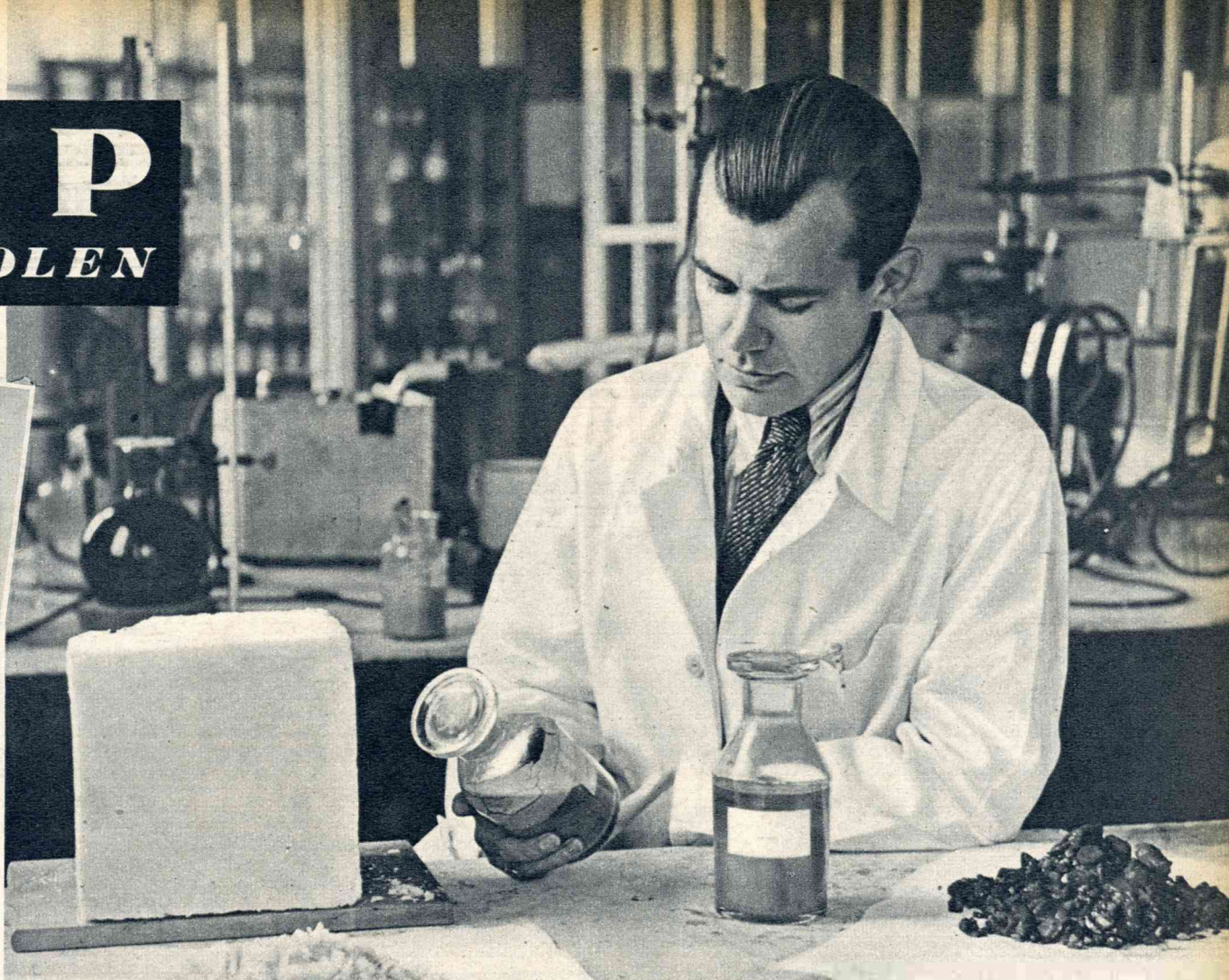
In kleine hoeveelheden ziet men hier de verschillende fasen aangegeven. Van rechts naar links: steenkool, koolwaterstof, vetzuur, zeep.
