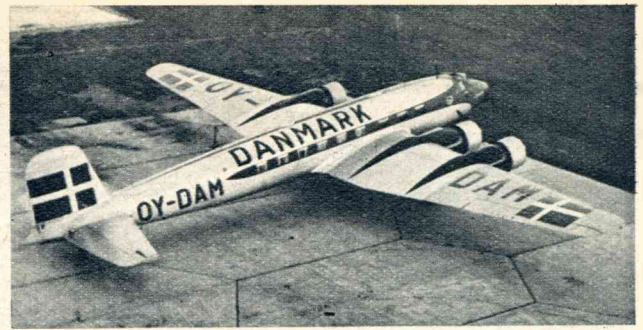
Dit is de „Danía”, een D.D.L.-Condor-vliegtuig voor den luchtdienst op Londen. Het vliegtuig bezit 4 B.M.W.-motoren en heeft een kruissnelheid van 335 km. per uur. Om verwisseling met andere vliegtuigen te voorkomen zijn de Condor-vliegtuigen geheel oranje geverfd, met den naam „Danmark” in groote zwarte letters op den rug.
