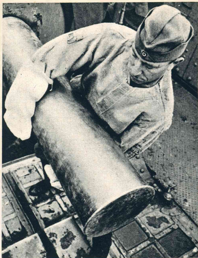
Na het schot wordt de kardoes verwijderd. Een jasje van stevige stof en asbesthandschoenen beschermen den kanonnier tegen de hitte van de kardoeshuls.
