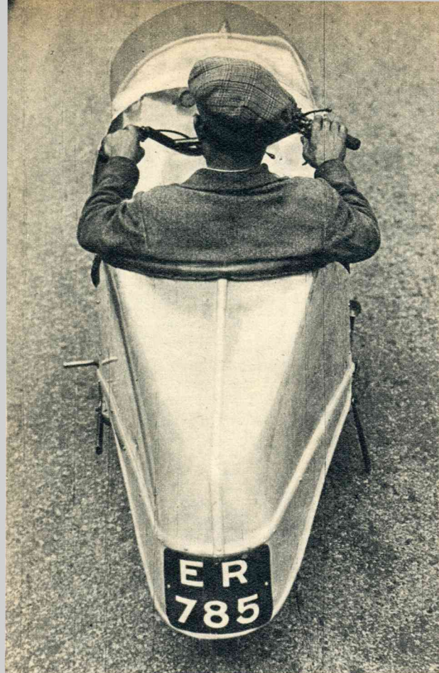
Dit motorrijwiel van A. N. Silvain, een Portugees die in Engeland woonachtig is, weegt slechts 180 pond. Het is ombouwd met aluminium en door z'n stroomlijn kan het een hoge snelheid bereiken. Of het in bochten zich gemakkelijk laat manoeuvreren lijkt nog de vraag.
