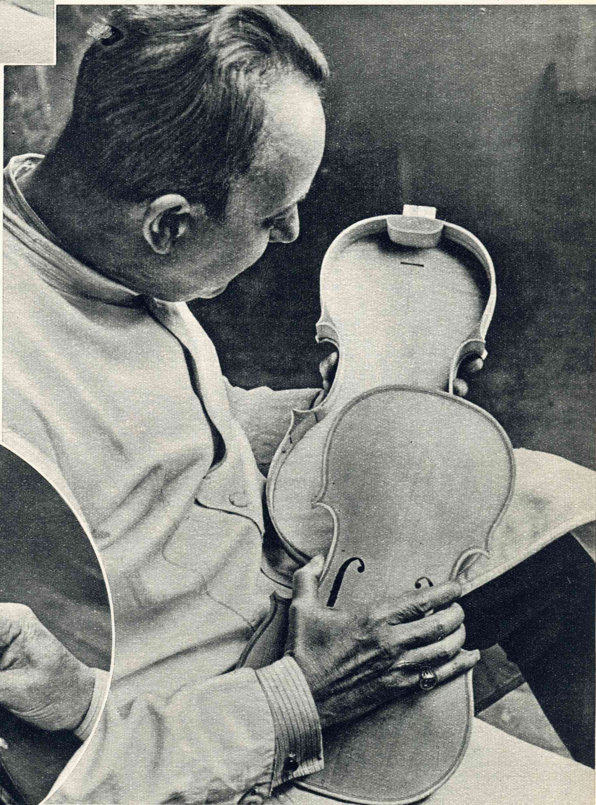
De bladen worden op elkaar gepast. Links: De viool nadert haar voltooiing. — Het opzetten van den kam.
