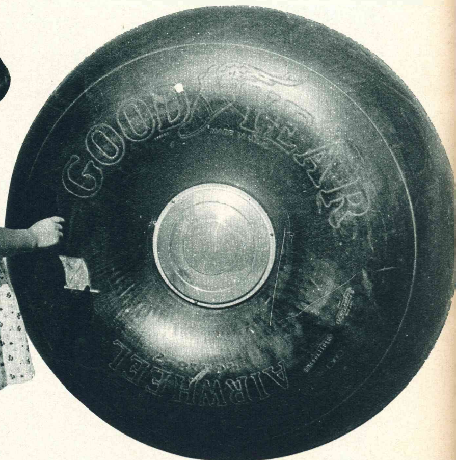
Een der enorme ballonbanden, die tijdens de vlucht met landingsgestel en al worden ingetrokken, en evenals de motoren geheel afgedekt om den luchtstroom geen weerstand te bieden.
