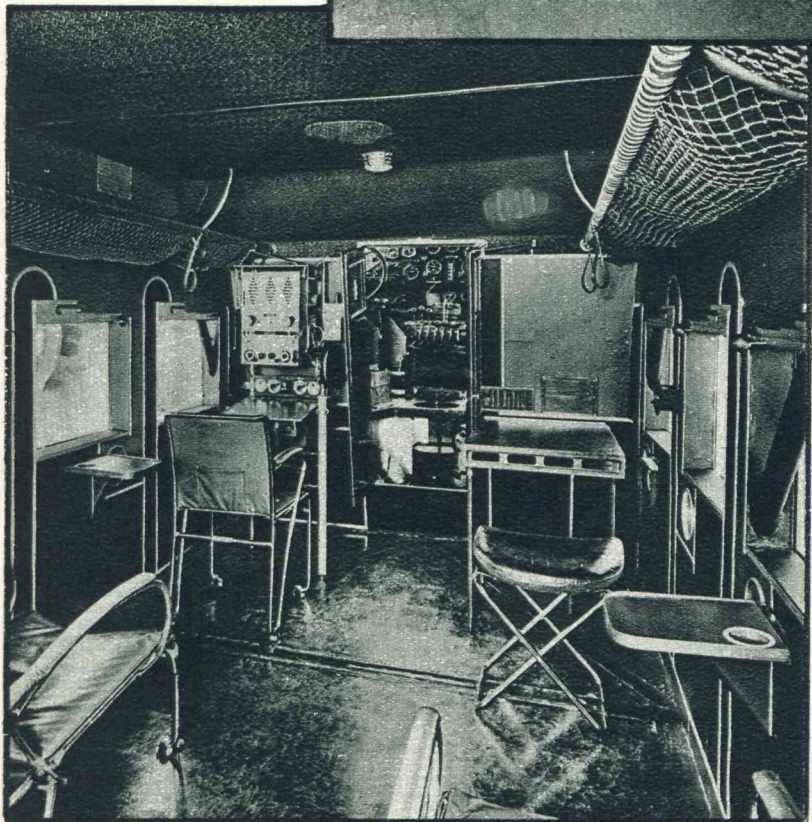
De radio-installatie, opgesteld in de cabine van een Indië-vliegtuig.
