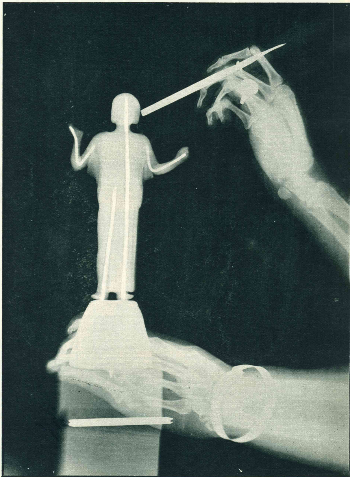
DE BEELDHOEWSTER, door den Röntgenfotograaf verrast. Door de pleister-massa van het beeldje heen wordt de metalen draadconstructie zichtbaar.
