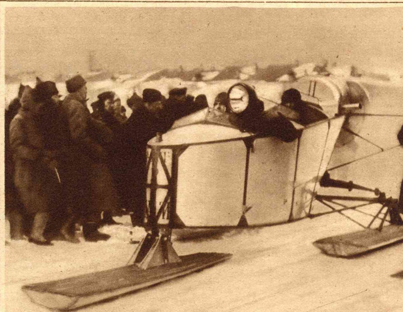
Een nieuwe sport in Rusland. Een aëroslede, een door een luchtschroef, die zich aan den achterkant bevindt, voortbewogen slede, waarmee een razende snelheid bereikt kan worden.
