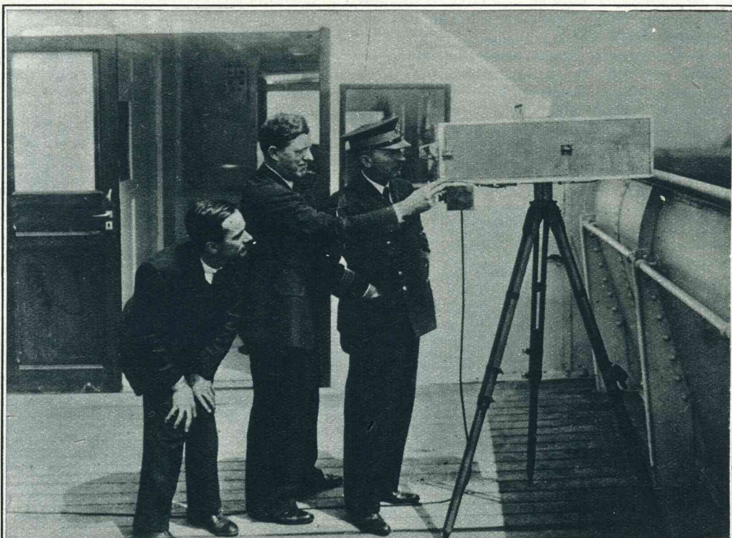
De mist-camera, die twee keer per minuut den weg vóór het schip in beeld brengt, zoodat men weet wat er op het water gebeurt, zonder dat men wegens den mist iets kan zien.
