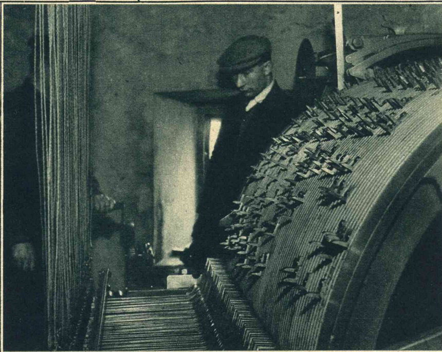
De speeltrommel van het Vlissingsche carillon, die het automatisch kwartierspel regelt.
