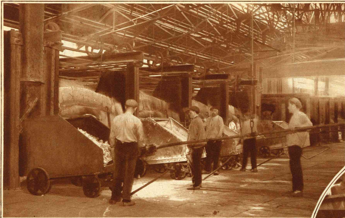
De grondstoffen, zand, natriumsulfaat en gemalen kalksteen, worden toegevoegd aan de ovens.
