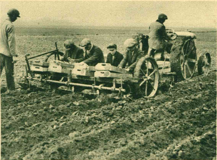
Een aardappelpootmachine, geconstrueerd door den heer Couwenhoven te Alkmaar. Met deze machine kan men per dag ongeveer vier bunders beplanten.
