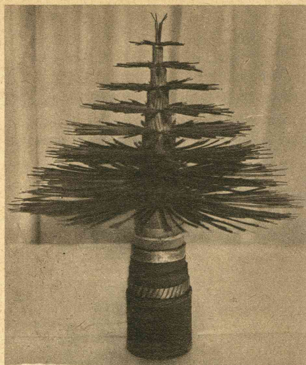
Een opengesneden telefoonkabel. Voor elken abonné zijn twee draden bestemd.
