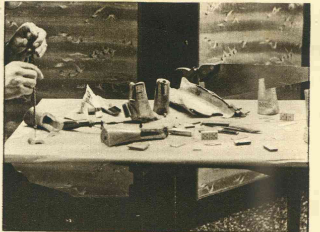
Hoe een dominosteen vervaardigd wordt: het boren der oogen.
