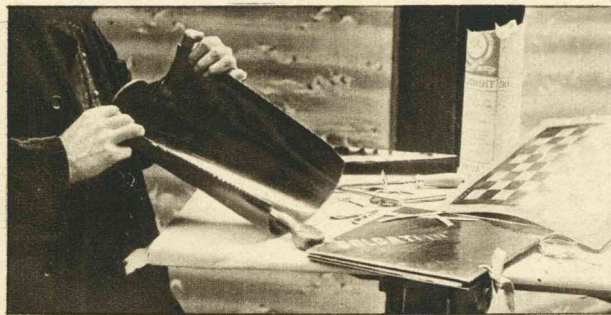
Hoe van een ronde bus een vlakke plaat gemaakt wordt.
