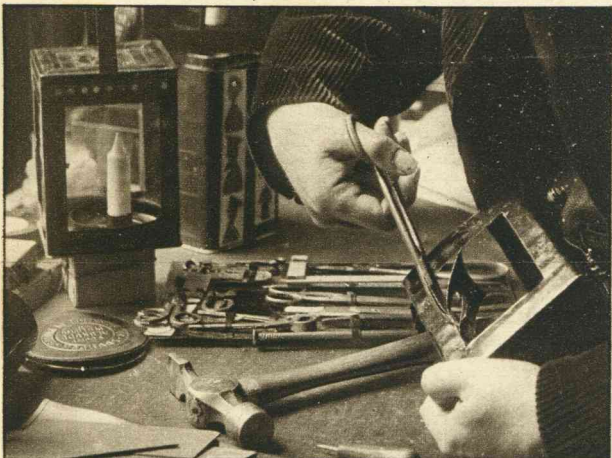
De eerste „operatie” welke van een beschuitbus een hand-lantaarntje helpt maken, (men lette op den instrumentendrager op de tafel; daarmee, en daarmee alleen doet de heer Prince al zijn werkjes).
